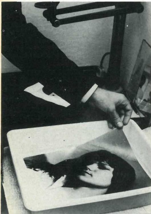
Fig. 4 - Durante la stampa e lo sviluppo degli ingrandimenti si opera alla luce della lampada di sicurezza giallo-verde: è così possibile osservare l'immagine che gradatamente si rivela sulla carta sensibile.
