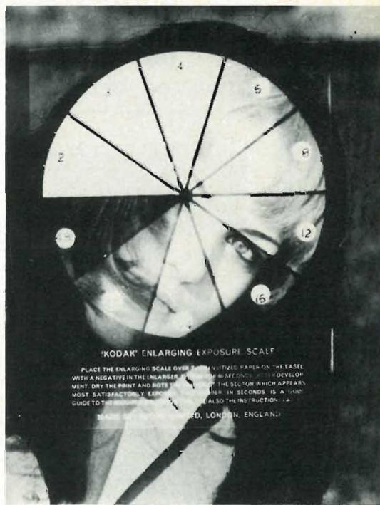
Fig. 6 - Per determinare l'esatta esposizione si sovrappone la scala per ingrandimenti alla carta vergine, quindi si espone per 60 secondi, si sviluppa e si fissa. Si osserva poi il provino così ottenuto e si sceglie il settore correttamente esposto: nello stesso settore si legge il tempo di posa in secondi; in questo caso 48...
