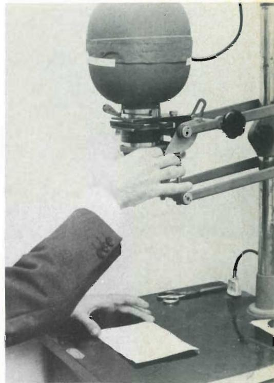
**Fig. 3 - Per ottenere stampe nitide è necessaria una perfetta messa a fuoco dell'obiettivo dell'ingranditore: per questa operazione il diaframma dovrà risultare a piena apertura.**
